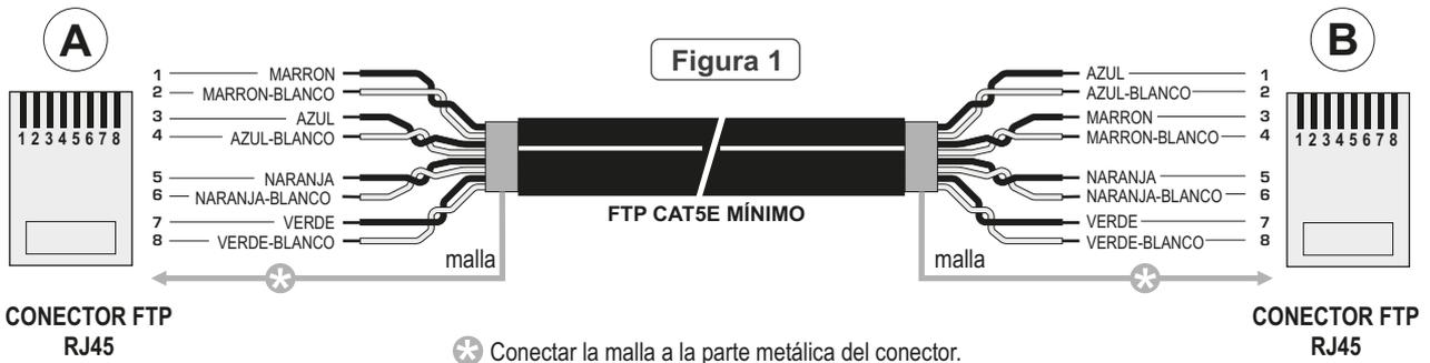
⊛ Conectar la malla a la parte metálica del conector.
