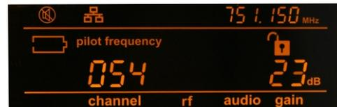
Con el emisor a unos 10-15cm del receptor, pulsar pulsar el botón **SET** del receptor para iniciar la sincronización. Durante este proceso se mostrará **SYNC** en la display del MR-400.
