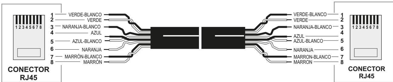
**6.5.2. Cable RJ-45 cruzado o "Crossover Cable".** Se utiliza para conectar el GD-37 directamente a un ordenador que disponga de una conexión Ethernet RJ-45 desde el conector del GD-37 marcado como (
