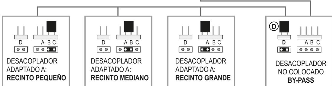
NOTA: El amplificador sale de fábrica configurado del siguiente modo:
