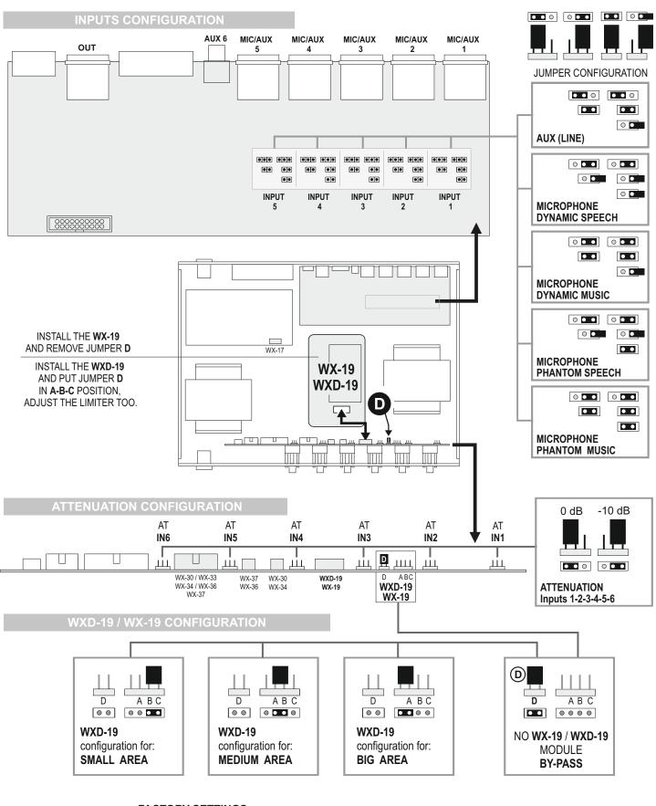
OPEN THE POWER AMPLIFIER AND BUT THE JUMPERS ACCORDING THE AUDIO INPUT SETTINGS DESIRED
