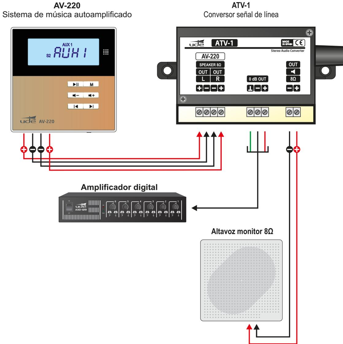
El equipo se puede conectar a la entrada del amplificador de 3 maneras distintas
