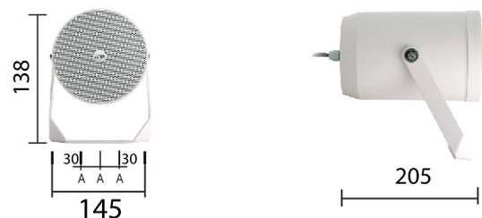
A= 3 Tornillos de anclaje (Ø6 mm)
