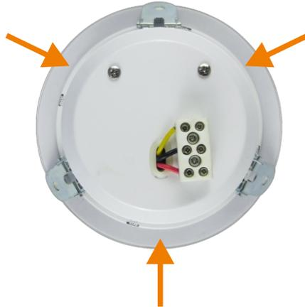
2. Conectar el cable con el terminal faston según la potencia de salida en el transformador de línea. La potencia de fábrica por defecto son 6W.
