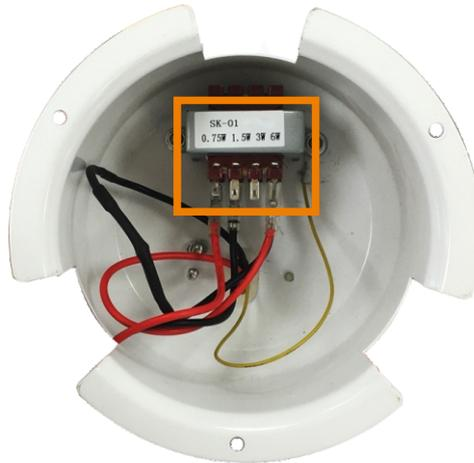
3. Una vez finalizado el cambio de potencia del altavoz, atornillar de nuevo los 3 tornillos de fijación del capot.
