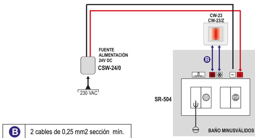
**B** 2 cables de 0,25 mm<sup>2</sup> sección mín.
