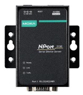
El puerto RS-232 (macho) del interface se conecta al extremo hembra del cable serie RS-232 suministrado con la caja de conexionado UW-102, ya conectado a esta por su otro extremo. El puerto Ethernet del interface puede conectarse a un cable Ethernet para interconectarlo con la LAN del cliente, o para hacer su configuración inicial puede conectarse directamente a un ordenador, utilizando un cable Ethernet CRUZADO.
