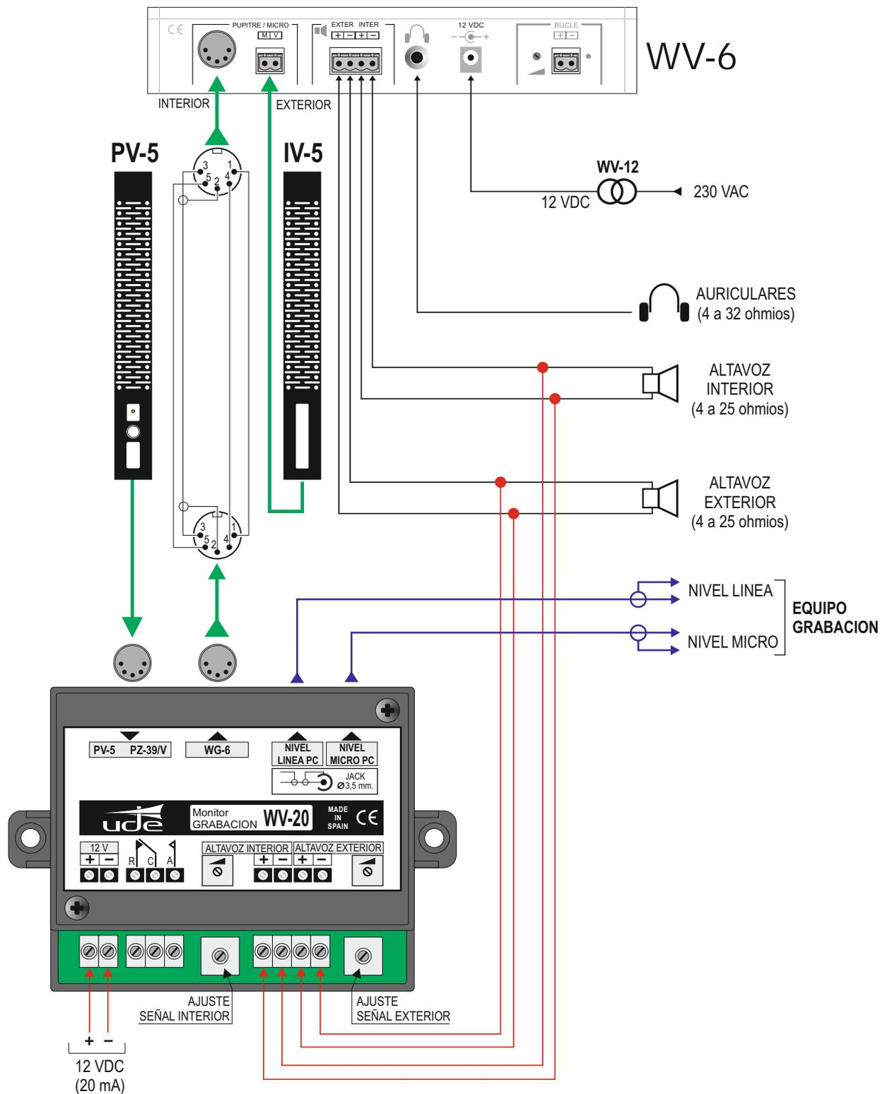
**Nota:** Para la alimentación del WV-20 se puede utilizar un alimentador de 12 Vdc, o conectarse al alimentador de 12 Vdc. del WV-6, (el consumo es muy reducido: 20 mA).
