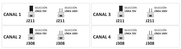
La configuración de fábrica es con línea 100V.
