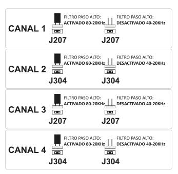
La configuración de fábrica es con el filtro activado 80Hz-20KHz
