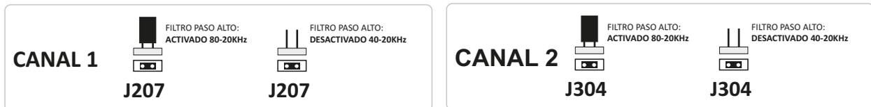
La configuración de fábrica es con el filtro activado 80-20KHz
