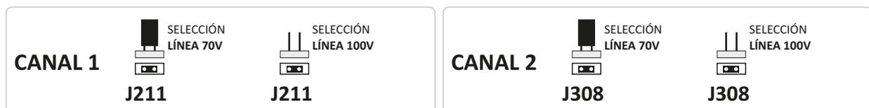
La configuración de fábrica es con línea 100V.
