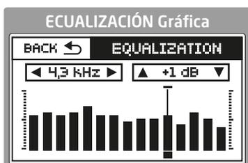
Mediante el menú "EQUALIZATION" se permite el control mediante DSP de hasta 15 frecuencias:
