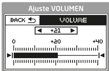
Mediante el menú "VOLUME" se puede variar el nivel de presión sonora en un rango de 0 a 40.
