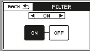
Mediante el menú "FILTER" se puede activar (ON) o desactivar (OFF) un realce de la respuesta frecuencial de la voz.
