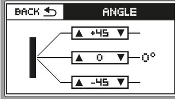
Mediante el menú "ANGLE" se puede variar de forma electrónica la dirección del haz principal para ser inclinado hacia arriba (+) o hacia abajo (-) en una escala del +45 al -45.
