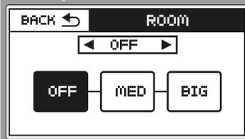
Mediante el menú "ROOM" se puede activar la configuración antilarsen en función del tipo de sala a sonorizar:
