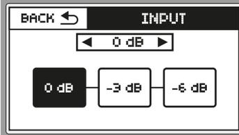
Mediante el menú "INPUT" se puede escoger 3 tipos de sensibilidad de entrada: 0dB / -3dB / -6dB.
