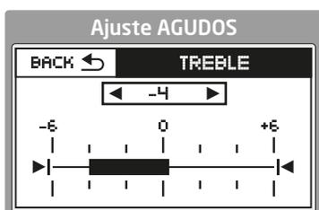
Mediante el menú "TREBLE" se puede incrementar o atenuar el nivel de AGUDOS en pasos de 2 dB hasta -6 o +6.
