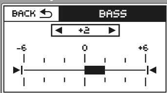
Mediante el menú "BASS" se puede incrementar o atenuar el nivel de GRAVES en pasos de 2 dB hasta -6 o +6.
