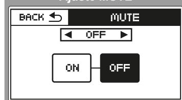
Mediante el menú "MUTE" se puede activar (ON) o desactivar (OFF) el volumen general de la columna.
