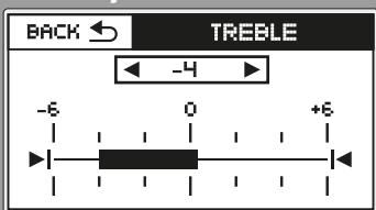
Mediante el menú "TREBLE" se puede incrementar o atenuar el nivel de AGUDOS en pasos de 2 dB hasta -6 o +6.
