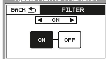
Mediante el menú "FILTER" se puede activar (ON) o desactivar (OFF) un realce de la respuesta frecuencial de la voz.
