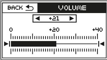
Mediante el menú "VOLUME" se puede variar el nivel de presión sonora en un rango de 0 a 40.
