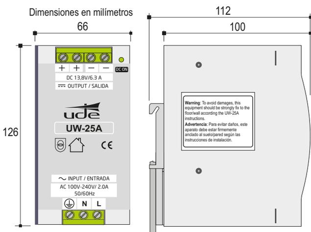
**Advertencia:** Para evitar daños, este aparato debe estar firmemente anclado al suelo/pared según las instrucciones de instalación.
