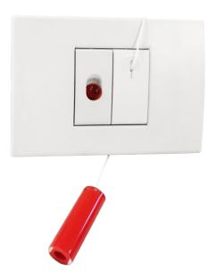
Módulo de llamada para instalación en baños individuales o geriátricos. Dispone de un cordón aislante para activar la llamada y de un led de tranquilización.
